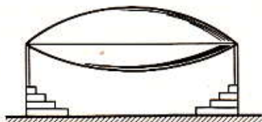
Рис. 36. Перекрытие в виде двойной мембраны
