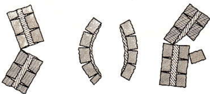
Рис. 45. Виды разрушения современной каменной кладки
